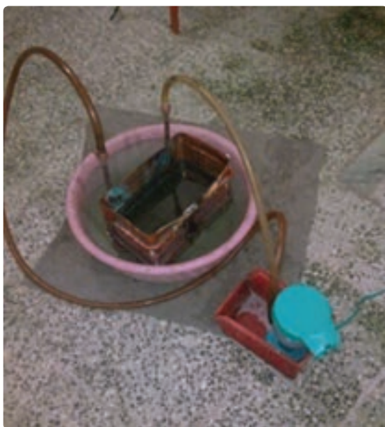
شکل ۱۹-۵- رسوب‌زدایی با پمپ
