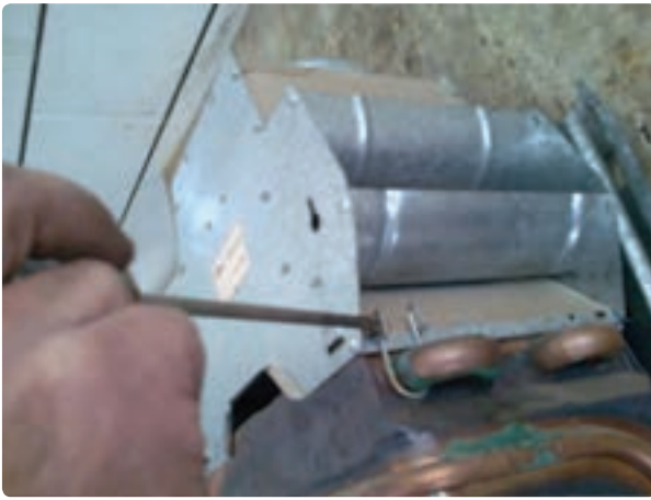
شکل ۶-۱- جدا کردن کلاهک تعدیل از مبدل
