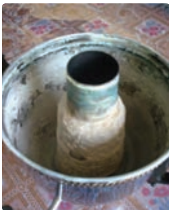
شکل ۸-۵- تشکیل رسوب در سماور و لوله‌ها
