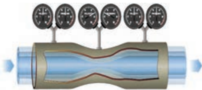
شکل ۳-۳۳- تغییرات فشار و سرعت در یک شیپوره
