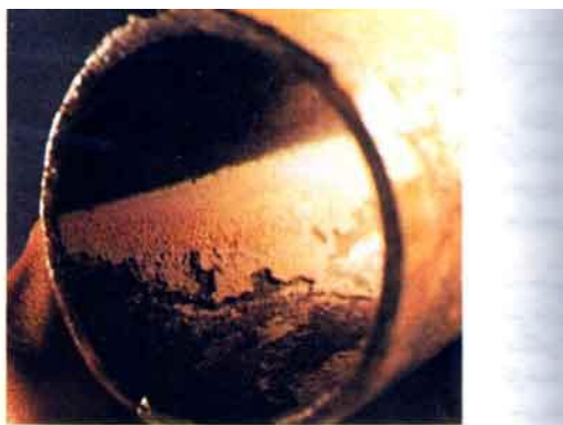
شکل (۲۲-۱) - لایه ته نشین روی سطح داخلی قسمت داغ یک لوله مقداری ته نشین در قسمت یادکردگی کم عمق مشاهده است. مرزهای تیز، نشان دهنده پایان پوشش بخار می باشد.
