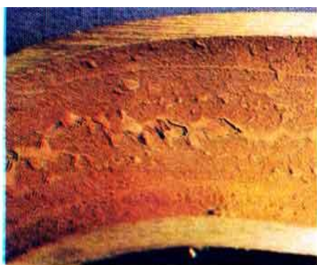
شکل (۱-۵) - لایه های خرد شده روی سطح داخلی یک اکونومایزر. آهن زیادی در محل تشکیل شده بود. اما مقداری به صورت خرد و جیبس جابه جا شده بود.
