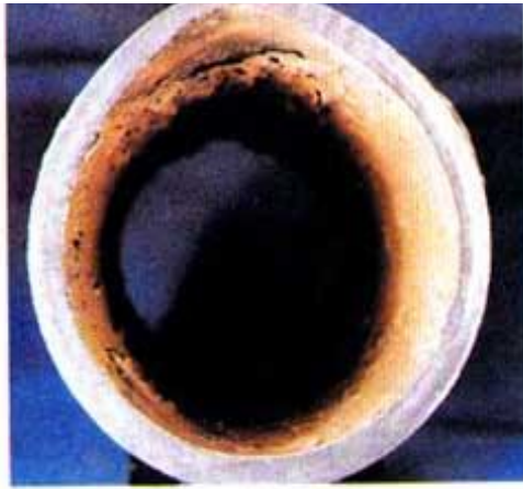
شکل (۱-۲۴) - سطح مقطع دیواره یک لوله باد کرده. ته‌نشست زیادی در هر دو قسمت سرد و داغ وجود دارد. ته‌نشست‌ها، فسفات‌ها، سیلیکات‌ها و کربنات‌ها می‌باشند.
