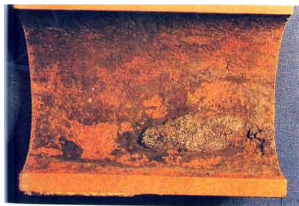
شکل (۱-۱۶) - وصله کریستال براق مگنتیت مربوط به محل خوردگی ناشی از سود این نوع کریستال ها اغلب در محل های مربوط به خوردگی ناشی از سود و اسید پیدا می شوند.
