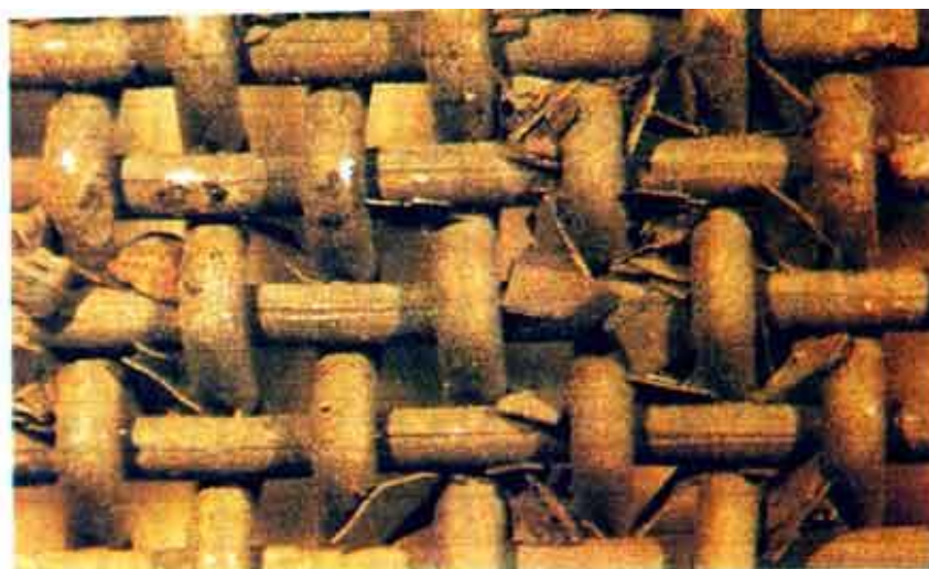
کل (۷-۱) - لایه ای از توری ورودی به توربین با مش نرم که قطعات ورقه ورقه شده اکسید از لوله سوپرهیتر به روی ریچه های توربین منتقل، که به صورت جدا شده ملاحظه می گردد (بزرگنمایی: ۷/۵ ×).
