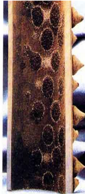
شکل (۱-۱۴) - نقاط مربوط به ته نشینت اکسید آهن خاصی که موقتاً مشخص دیواره یک دیگ بخار بازمانده را منعکس می نماید. محل مشخص شده اگر در معرض حرارت متمرکز قرار گیرند موجب سرعت بالای تولید بخار و ته نشینی می شوند. به ته نشینت های سید هیدروکسید سدیم که هر منطقه به مگنتیت را احاطه کرده توجه شود.
