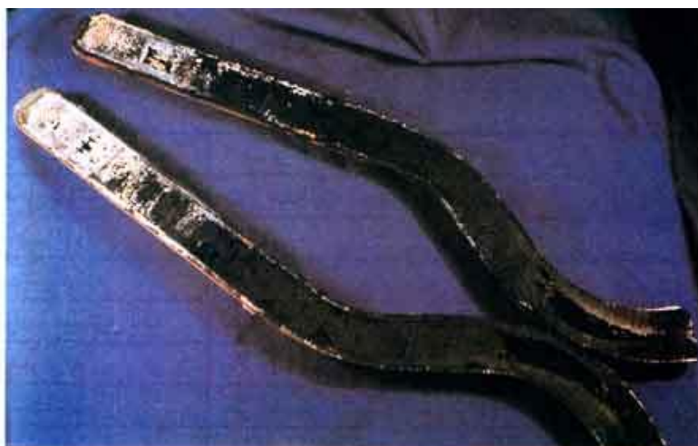
شکل (۲۱-۱) - شکاف طولی قسمت اتصال گرفته از خروجی یک سوپرهیتر. لوله یا ته نشینت ها دچار گرفتگی شده است. سفید هیدروکسید سدیم و کربنات سدیم تغلیظ شده در قسمت پایین محل گرفتن اتصال، ماده سیاه عمدتاً مگنتیت است.
