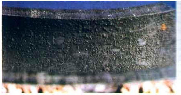
شکل ۲۳-۱- به تاول های مگنتیت روی سطح داخلی یک خم U شکل در سوپرهیتر اژیته که در جاهایی طبقه طبقه شده است توجه شود.
