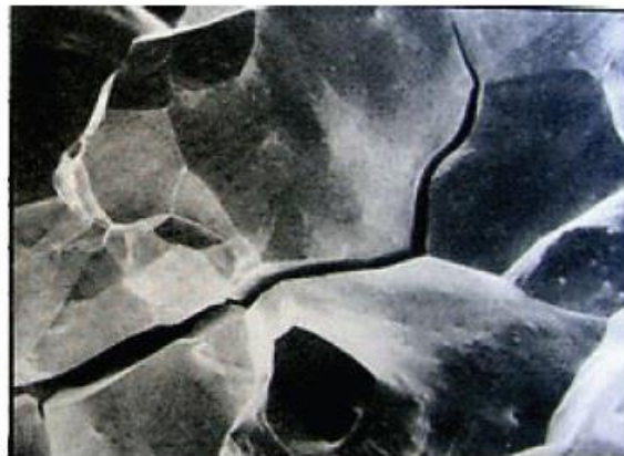
ترک های زیاد در سطح نقطه جوشکاری شده
