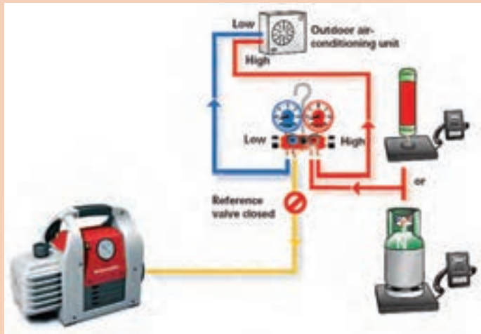
شکل ۱۶- طریقه اتصال شیلنگ شارژ به سیستم و کپسول ازت
