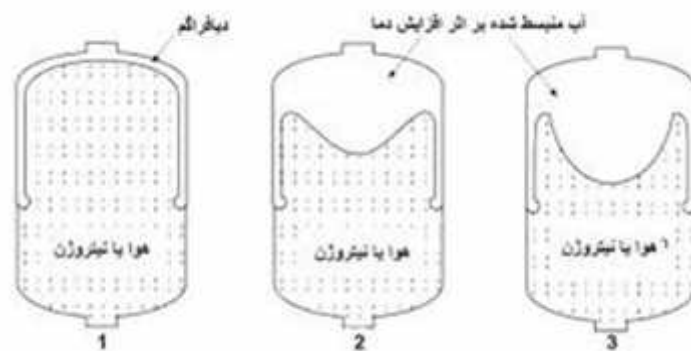
شکل 5- طریقه عملکرد مخزن دیافراگمی
